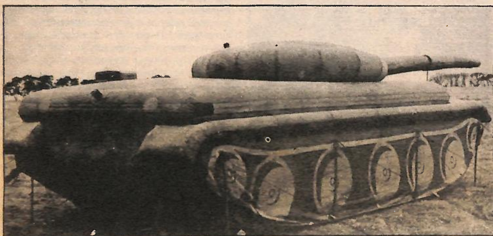
Tank gonflable : le seul gag d'une exposition par ailleurs sinistre. Entièrement en caoutchouc, il peut être utilisé comme cible d'entraînement ou comme leurre. Pour guerre-bidon où les armées se dégonfleraient à coups d'aiguilles à tricoter !
